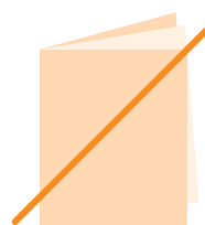
Einlage nicht bündig eingeklebt
